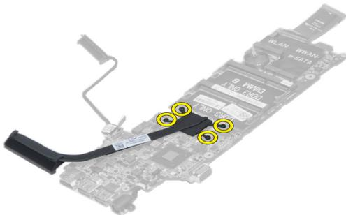
4. Extraiga el disipador de calor de la placa base.
