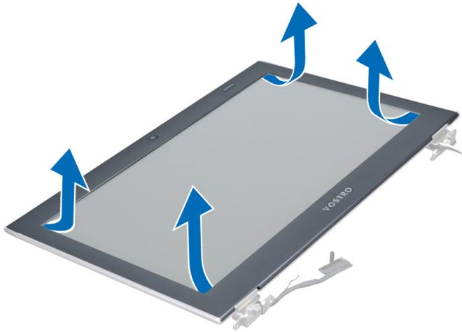
4. Levante el embellecedor de la pantalla y retírelo del ensamblaje.
