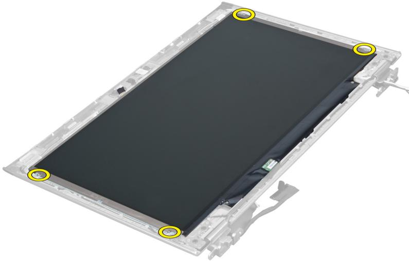
5. Dele la vuelta al panel de la pantalla de su ensamblaje.
