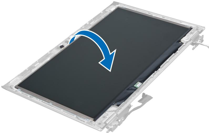
6. Coloque el panel de la pantalla con la parte frontal hacia abajo para acceder a los cables de la pantalla y de la cámara conectados a la misma.
